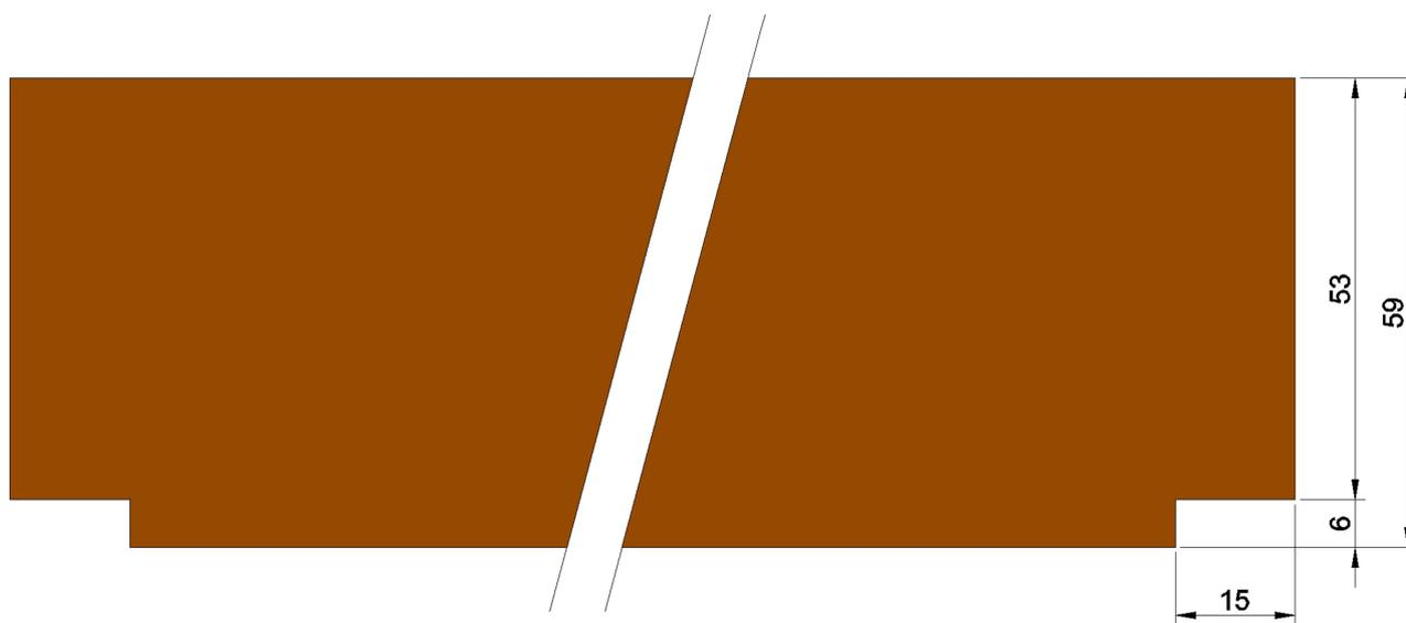
Mesure pour joint 5mm
